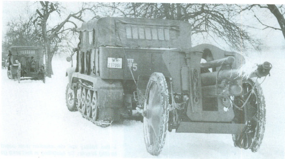
Een I.F.H.18 achter een 5 ton L8 mittl.Zugkraftwagen (in 1938-'39 gebouwd door Büssing-NAG en Daimler-Benz.
